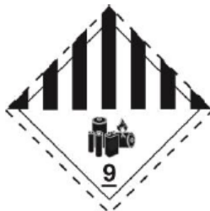
Fig. 25. No. 9A. Símbolo (siete barras verticales negras en la mitad superior; un grupo de baterías, una rota y emitiendo llama en la mitad inferior): negro; Fondo: blanco; La cifra "9" subrayada en la esquina inferior
