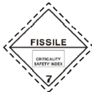
Fig. 22. Material fisionable (7E). Fondo: blanco; Texto (obligatorio): Negro en la mitad superior de la etiqueta "FISSILE"; En un cuadro delimitado con negro en la mitad inferior de la etiqueta la frase "CRITICALITY SAFETY INDEX". La cifra "7" en la esquina inferior.
