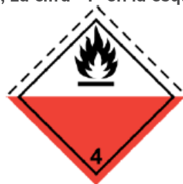
Fig. 14. División 4.2. Sustancias susceptibles a combustión espontánea. Símbolo (llama): negro; Fondo: mitad superior en blanco, mitad inferior en rojo; La cifra 4 en la esquina inferior.
