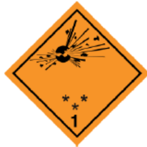
Fig. 7. Divisiones 1.1, 1.2, 1.3. Símbolo (bomba explotando): negro; Fondo: naranja; La cifra "1" en la esquina inferior.
