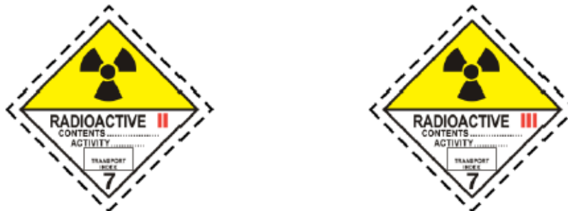
Fig. 21. Categoría II (7B) y III (7C). Amarilla. Símbolo (trébol): negro; Fondo: mitad superior en amarillo con borde blanco, mitad inferior en blanco; Texto (obligatorio): negro en la mitad inferior de la etiqueta, "RADIOACTIVE", "CONTENTS", "ACTIVITY"; En una caja delimitada con negro la frase "TRANSPORT INDEX"; La palabra "RADIOACTIVE" seguida de dos y tres barras rojas verticales para la Categoría II y Categoría III, respectivamente; La cifra "7" en la esquina inferior.
